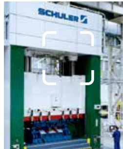
油圧プレスでの採用例 DGUV 認証品の安全装置
