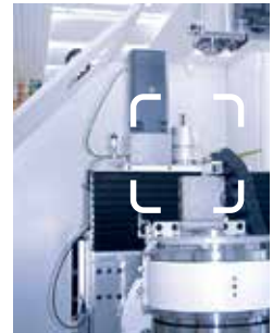
研削盤での採用例 緊急停止時や機械メンテナンス時の Z 軸の保持
